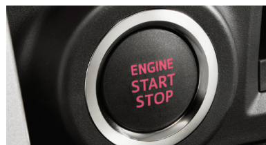
ระบบ Keyless Access พร้อมปุ่มสตาร์ทเครื่องยนต์
